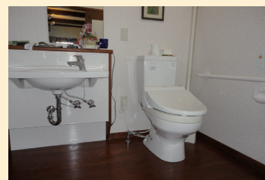
左・下／寝室から洗面化粧台・便所スペースを見る。ホームヘルパー等の介護者が利用する給湯・洗面機能を介護寝室と隣接させた。また、介護スペースを確保するため、便所と洗面所を一室とした。車椅子の移動が可能になるように、段差も解消している
