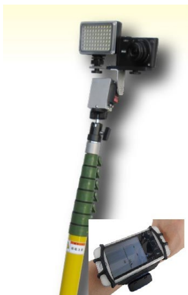
カメラを搭載した点検棒及び操作する際のタブレット機器
