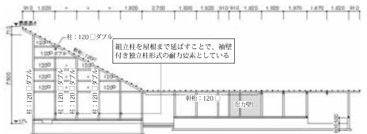
軸組図および組立柱詳細図(右上)
