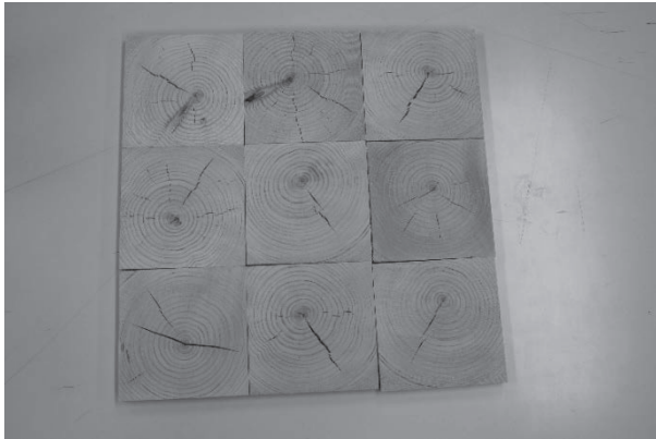
桧柱材内部割れ
